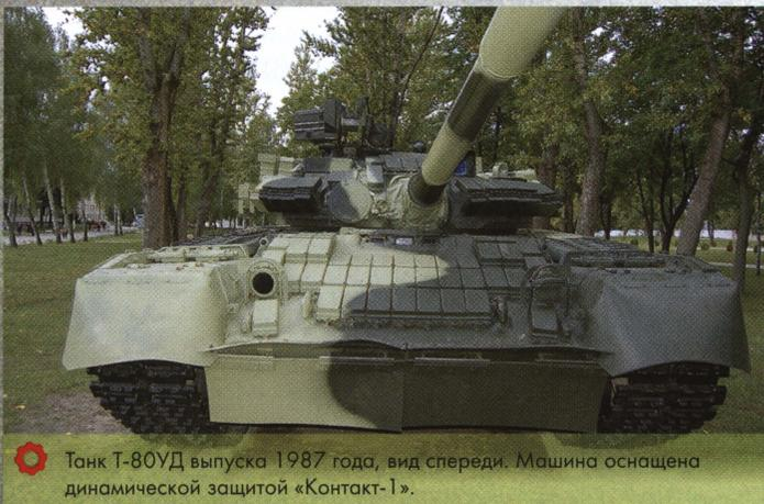
Танк Т-80УД выпуска 1987 года, вид спереди. Машина оснащена динамической защитой «Контакт-1».
