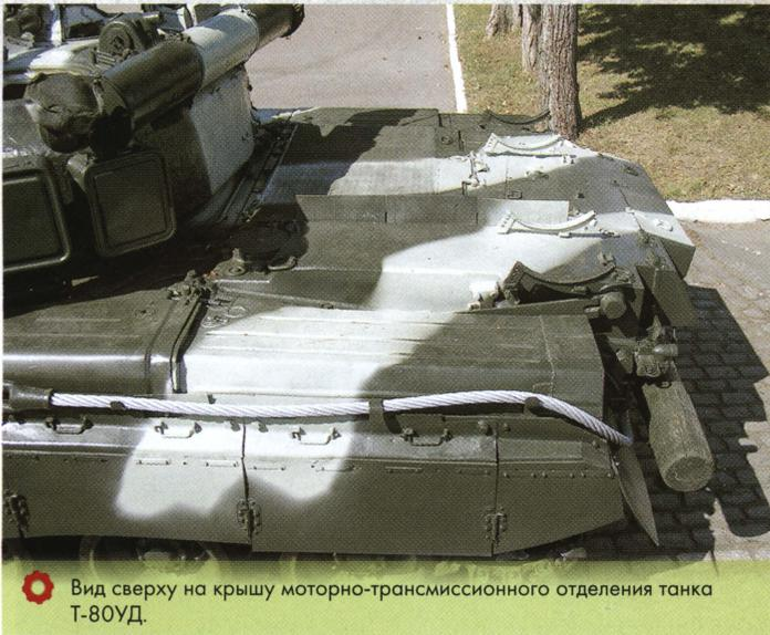
Вид сверху на крышу моторно-трансмиссионного отделения танка Т-80УД.
