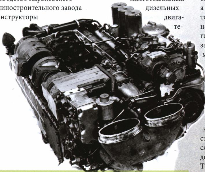
Танковый дизельный двигатель 6ТД мощностью 1000 л.с.
