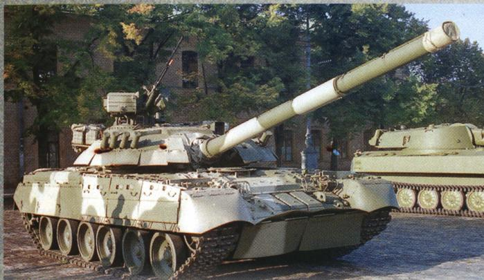
Танк Т-80УД выпуска после 1988 года со встроенной динамической защитой «Контакт-5».
