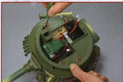
**8** Чтобы соединить детали между собой, открутите механизм поворота башни, удалив четыре винта.
